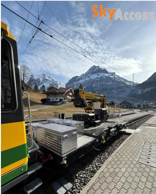
Die JR1050 EVO wurde speziell für die Montage auf einem lastabhängigen, gebremsten Güterwagen (Modultragewagen) von der Firma Ferdinand Steck Maschinenfabrik AG entwickelt und eignet sich perfekt für den Unterhalt der Bahnanlagen und elektrischen Hochleitungen von Zahnradbahnen.
