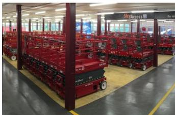
Die elektrischen Scherenarbeitsbühnen von Skyjack wollen wir natürlich nicht aussen vor lassen. Sie sind alle wendig, kompakt, mobil und perfekt für Jobs in Innen- sowie Aussenbereichen. Sie erreichen eine Arbeitshöhe von 6.40 – 13.86 m und eine Tragfähigkeit von 227 – 590 kg. Die Plattform ist ausrollbar und kann somit um ca. einen Meter vergrössert werden.
