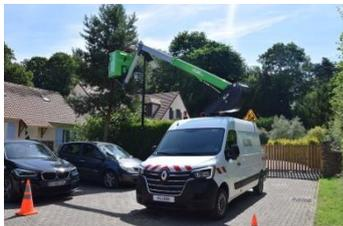
Ein grosses Augenmerk möchten wir auf die elektrischen, selbstfahrenden Arbeitsbühnen von KLUBB legen. Die KL26 und K20 L bieten eine Tragfähigkeit von 120 kg, eine Arbeitshöhe von 10.50 bis 11.80 m und eine Reichweite von 5.80 bis 6.80 m. Mit beiden Arbeitsbühnen kommen Sie überall hin und können die Geräte flexibel einsetzen. Durch den Van bieten sie zusätzlichen Stauraum an.
